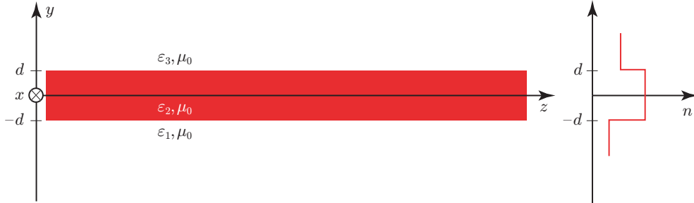
Figura 10.1: Lamina con indice di rifrazione maggiore di quello dei mezzi contigui.
